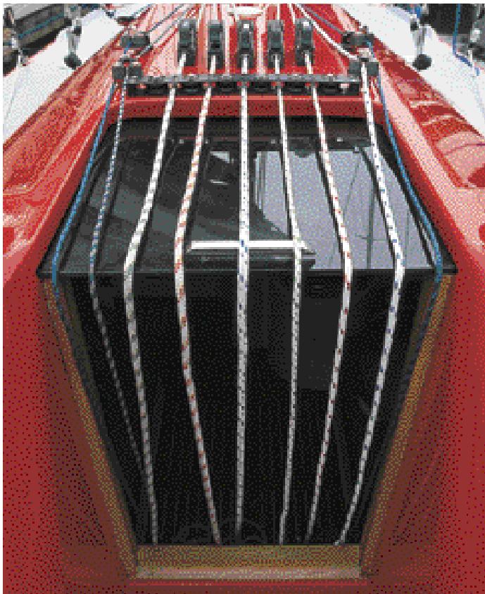
Schnelle Manöver verlangen schnellen Zugriff auf Fallen und Strecker: Bei geöffnetem Schiebeluk steht man im Schiff, von dort sind die Hebelklemmen optimal zu bedienen. Die verschiedenen Farben und Durchmesser helfen in der Hektik, die richtige Leine zu packen
