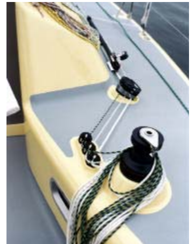
Aufgeräumt und griffbereit: Führung der Kontroll-Leinen unter Genuaschiene und Genuaschotumlenkern, durch die beide Schotwintchen benutzt werden können.
