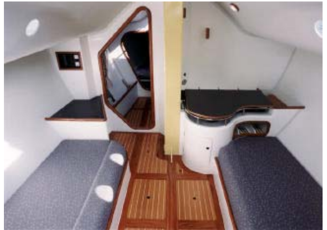
Blick in den Salon mit geschlossener Pantry, Abdeckung, die so auch gut etwa als Navigationsplatz genutzt werden kann.
