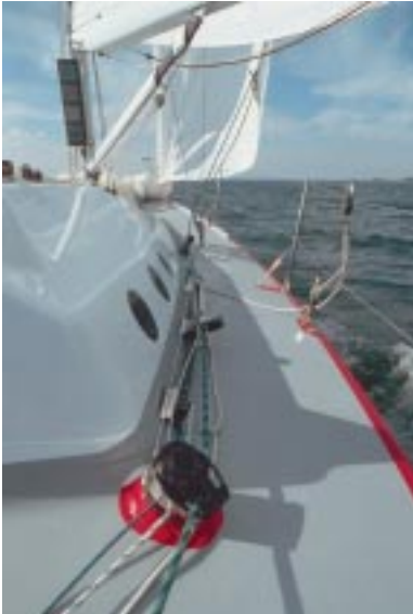
Der Holepunkt der Genua I ist auch unter Last verstellbar.
